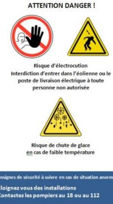
Figure 10 : Exemple de panneau d'avertissement installé au niveau d'une éolienne
